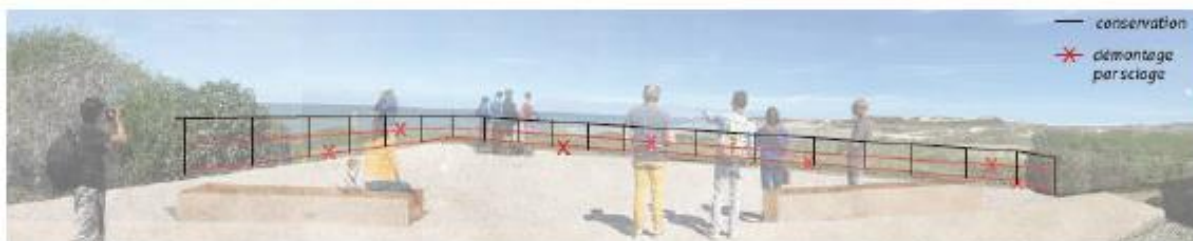
Année N+5 à 10: pelouses calcicoles renaturées et suppression des 2 fers horizontaux métalliques: conservation des montants verticaux et lisse métalliques
